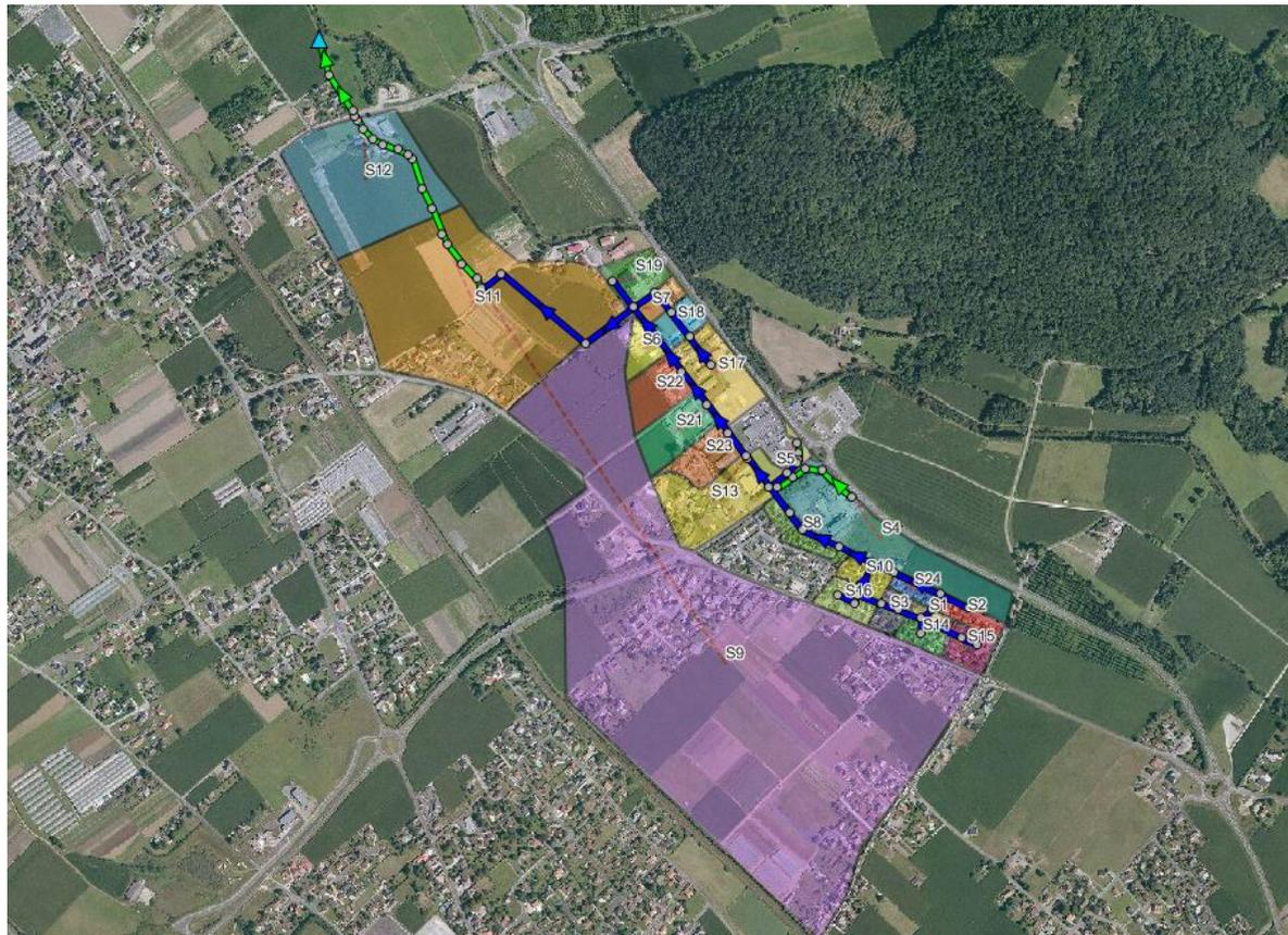
Le tableau ci-dessous présente les principales caractéristiques des sous bassins versants de Bordes Assat. Les caractéristiques sont issues de la modélisation sous PCSWMM où la forme du bassin est assimilée à un rectangle de longueur maximale égale à 150m.
